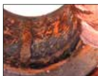
Corrosione e rottura sull'occhio della balestra dovute a trattamento superficiale insufficiente
